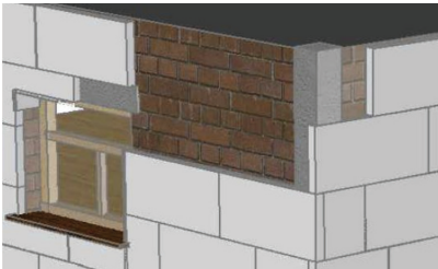
Պատկեր 18. Արտաքին պատերի ջերմամեկուսացման Քայլ 2-ի սխեմատիկ տեսքը
