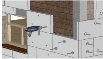
Պատկեր 19. Արտաքին պատերի ջերմամեկուսացման Քայլ 3-ի սխեմատիկ տեսքը
